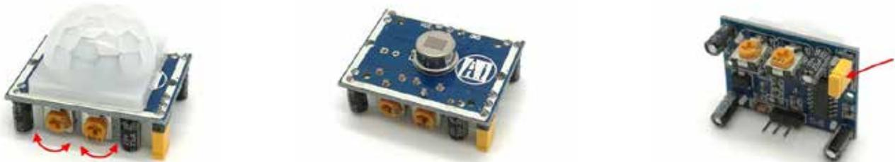
Die Kunststofflinse ist nur leicht gesteckt. Wenn man sie abhebt kann man den Infrarotdetektor erkennen und man sieht anhand der Beschriftung unter der Linse, wie der Sensor verkabelt werden muss: GND ( - ), OUT (Ausgang des Signals), VCC ( + ).
